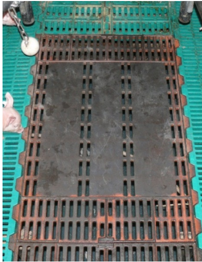
Abbildung 1: Darstellung des vorherigen Rosttyps „Mix 691/N“ mit einer geschlossenen Liegefläche von 0,36 m 2 mit 12 % Schlitzanteil, wie er vor dem Rostaustausch eingebaut war.
